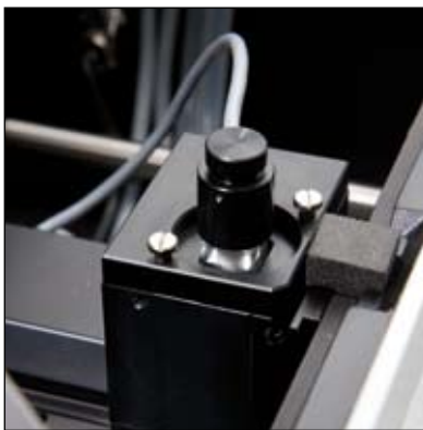
Der peltiertempertierte Küvettenhalter garantiert exakt temperierte Messungen, die Temperatur wird in der Küvette gemessen.
