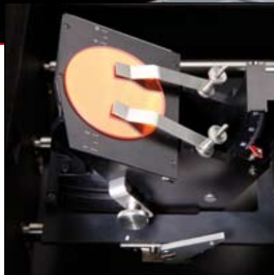
Reflexionsmesseinsatz mit variablem Winkel für Bestimmungen des Brechungsindex und der Schichtdicke
